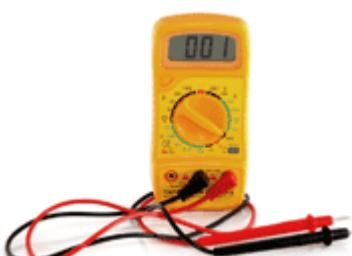
El Multímetro, polímetro ó tester es un aparato que sirve para medir voltios, amperios, ohmios y más cosas. Con una ruleta seleccionas qué es lo que quieres medir (en algunos modelos también hay que cambiar la posición de uno de los cables).
