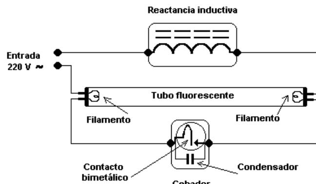
más tiempo en estropearse. Uno de los inconvenientes es que la instalación es un poco más compleja: además del tubo fluorescente hace falta la reactancia (suele ser una caja metálica muy pesada) y el cebador (un pequeño cilindro de plástico). Si tenemos todo el conjunto montado en una carcasa basta conectar los dos hilos finales a la red. En la figura se ve el esquema de como se montan las tres partes.
